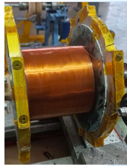
MC2 last layer with STYCAST
